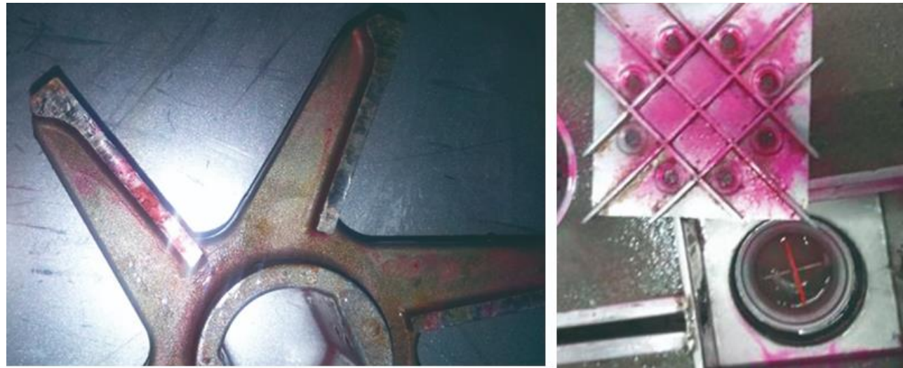
Figura 2. Presencia de biofilms en elementos de los equipos y drenajes de una sala de elaborados cárnicos.
