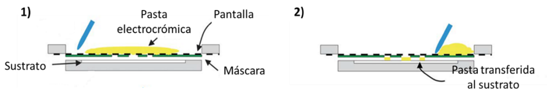
FIGURA 6. Procedimiento de impresión por serigrafía.
