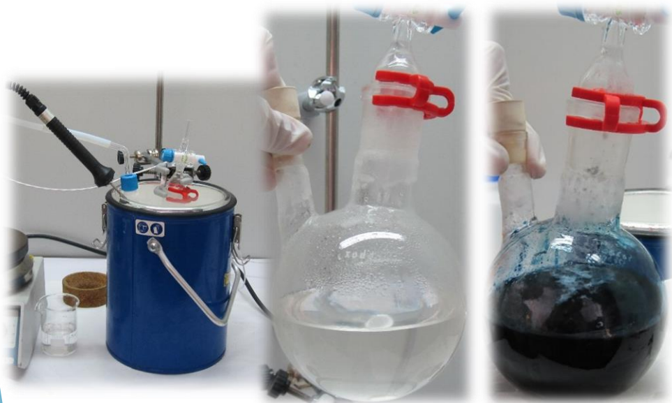
Condensar \text{NH}_3 ( -50^\circ\text{C} ) sobre la sal de Na
