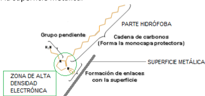
Figura 5. Interacción de un IC (imidazolina) con una superficie metálica.
